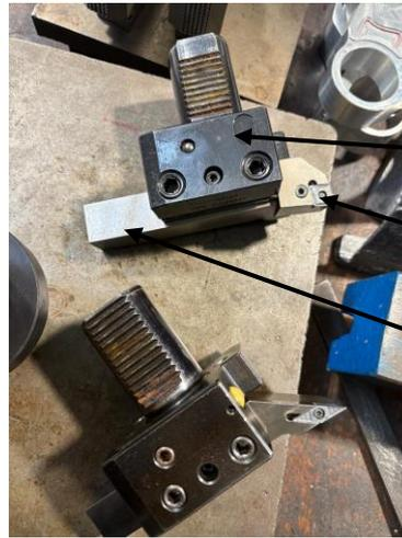
Figure 9 : outil du dessus PCLNL 2525M 12 avec plaquette CNMG 12 04 08-PM 4335
