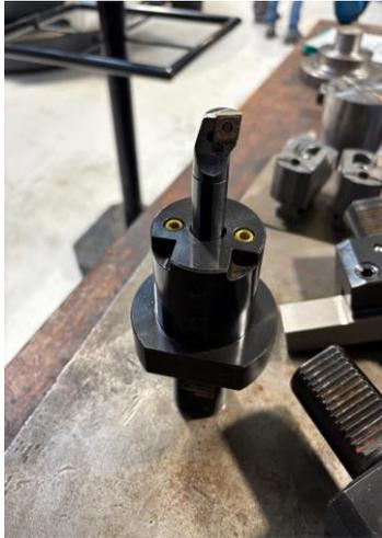
Figure 8 : S20S-PCLNL 09 avec plaquette CNMG 09 03 04-PF 4325
